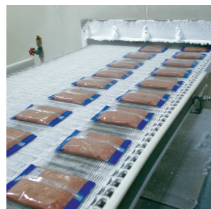
真空パックに詰められたたたき身は、スパイラルフリーザーで素早く冷凍状態に
