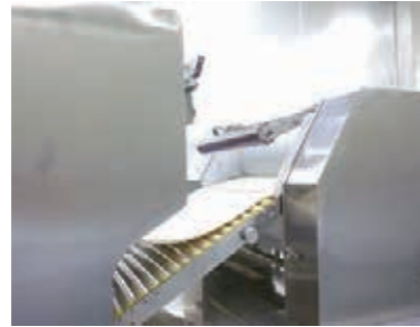
うどんの生地を伸ばす圧延機。10cmの厚みから何度も機械を通して薄くします。
