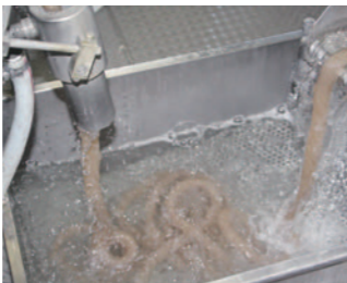
かしはら 株式会社 若草食品 榎原工場 奈良県榎原市にある榎原工場は、ねじり糸こんにやくを作るため150mの温水パイプを配した独特の構造になっています。
