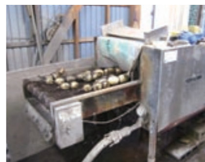
機械化により、大量の掘りたての泥つきレンコンもあっという間に洗いがります。
