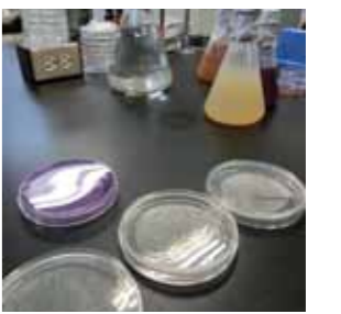
検査に使う試薬。菌の種類ごとに液が違います。出荷する製品だけでなく、使用する原料肉や製造機器に対しても様々な検査を行っています
